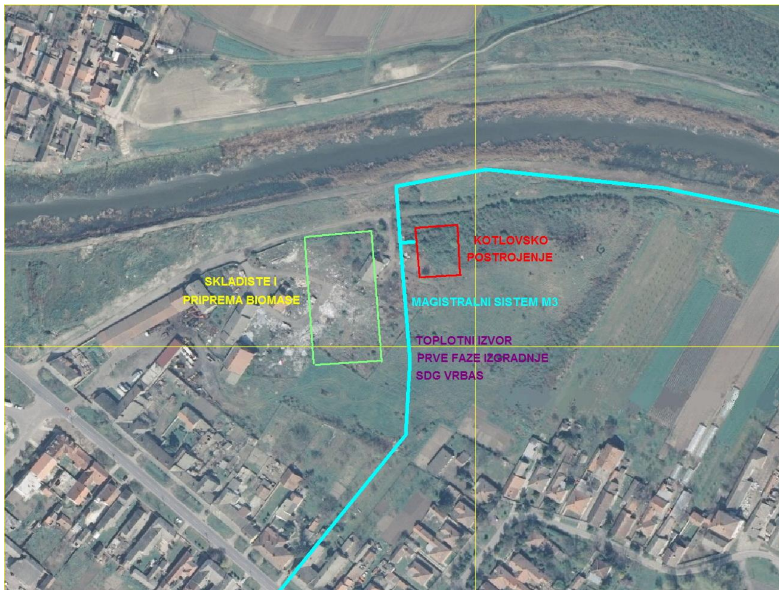
D1-02 Dispozicioni prikaz energetskog (kotlovskog) postrojenja i skladišta sa pripremom biomase TI prve faze izgradnje SDG Vrbasa
